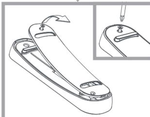
Öffnen Sie das Batteriefach.
