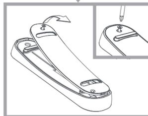
Öffnen Sie das Batteriefach.
